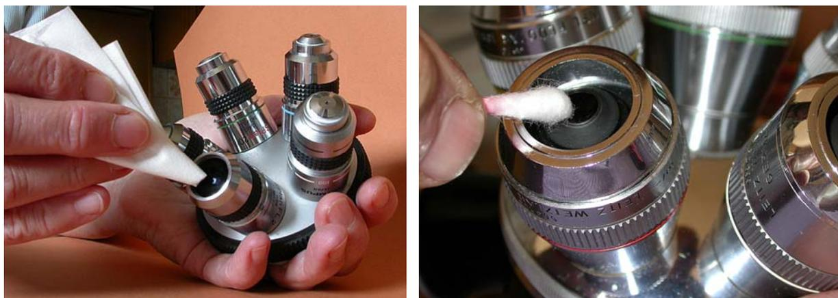
Le nettoyage de la surface optique se fait à l'aide d'un coton-tige (enveloppé ou non de papier optique), en partant du centre et en faisant un mouvement circulaire pour atteindre la périphérie.
