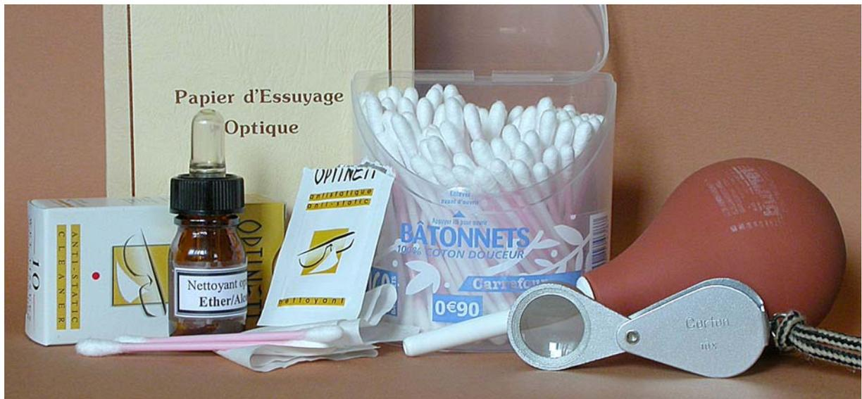
Le matériel indispensable : le nettoyant optique, la poire soufflante, les coton-tiges, le papier optique, les chiffonnettes imprégnées de nettoyant optique, la loupe pour vérifier l'état des surfaces optiques.
